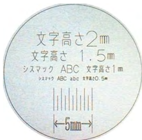
素材:ステンレス 黒色印字 高精度制御による微細な印字です
